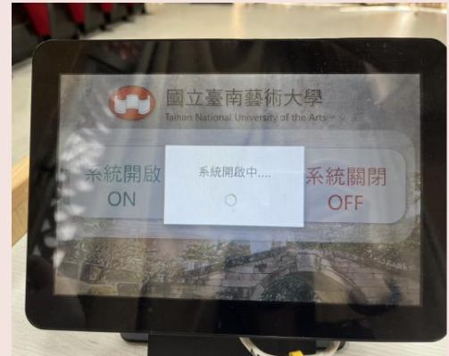
(1) 控制面板點選「系統ON」 (稍後等待系統跑完)。
